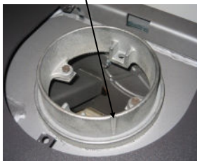
Markierung für den Kondensatablauf.
